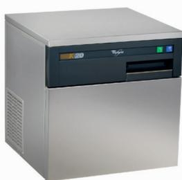
Durée du programme 15 mn, capacité de production : 24kgs/24h, glaçons en forme de cube, Stockage 10 Kgs, carrosserie acier inox AISI304, porte abattante.
